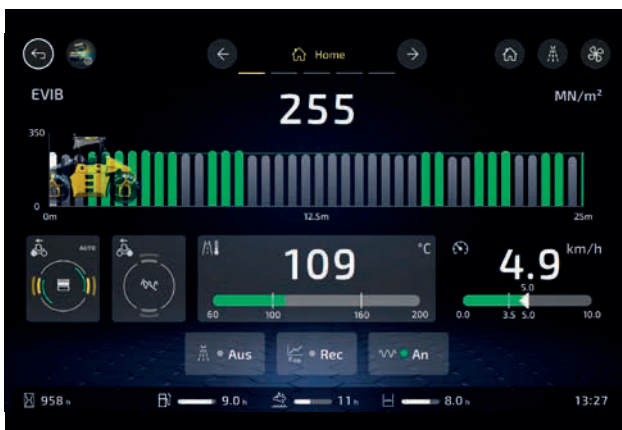
Übersichtliches Display: stets alle Werte sicher im Blick, Auswahl der Asphaltsschicht im Display (Abb. oben rechts).
