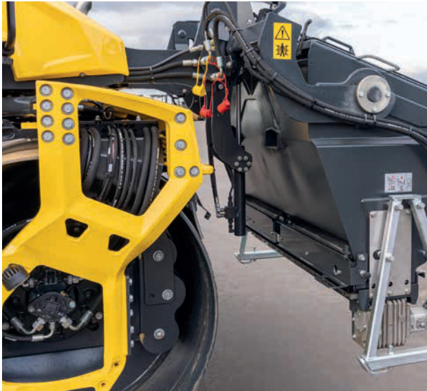
Die Präzisionsstreuer BS 150 und BS 180 eignen sich für alle gängigen Streugüter, z. B. Edelsplitter der Siebkörnung 2/5 und 1/3 oder Brechsand der Siebkörnung 0/2.
